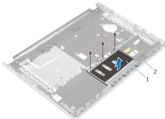
1 nosač podloge osjetljive na dodir
