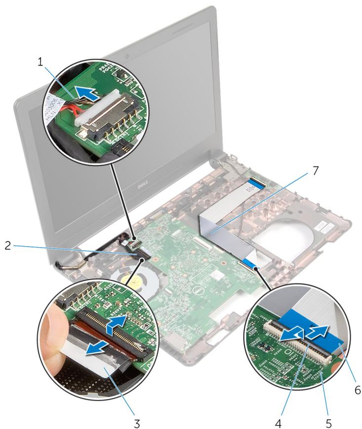
1 kabel priključka adaptera za napajanje
